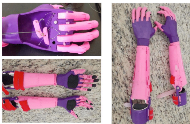
Figura 6 – Detalhes da montagem das próteses 3D. a) Parte da mão aberta. b) Vista anterior das próteses montadas. c) Vista anterior das próteses montadas.
