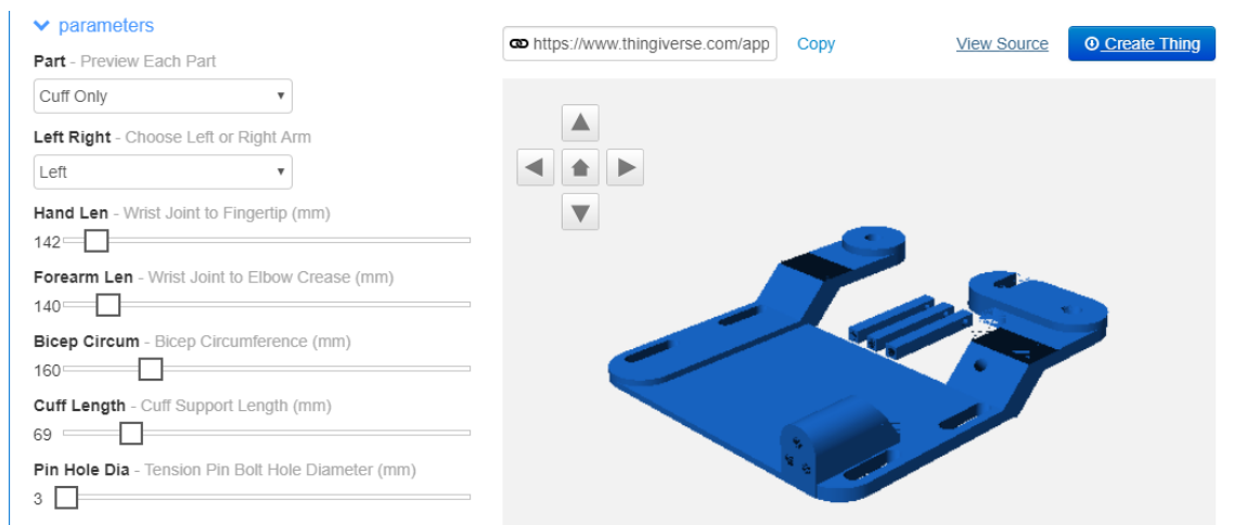
Figura 30. Modelagem 3D das peças que formam a prótese de acordo com as medidas do usuário. Fonte: Autores.
