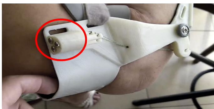
Figura 36 - Sistema de parafusos para ajuste dos filamentos. Fonte: Autores.
