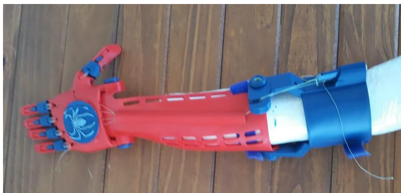
Figura 34 - Prótese modelada e montada usando fios multifilamento de polietileno. Fonte: Autores.
