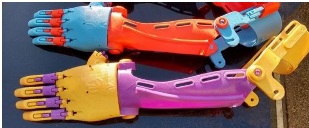
Figura 24 - Prótese transradial 3D, modelo The UnLimbited Arm v2.1 - Alfie Edition. Fonte: Team UnUnlimbited, 2019.
